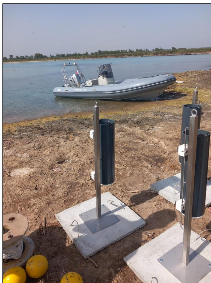
Figura 12 – Trappole sedimentarie prima dell'installazione
