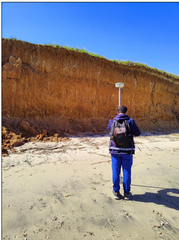
Figura 49 – Acquisizione GNSS durante il rilievo laser scanner 3D
