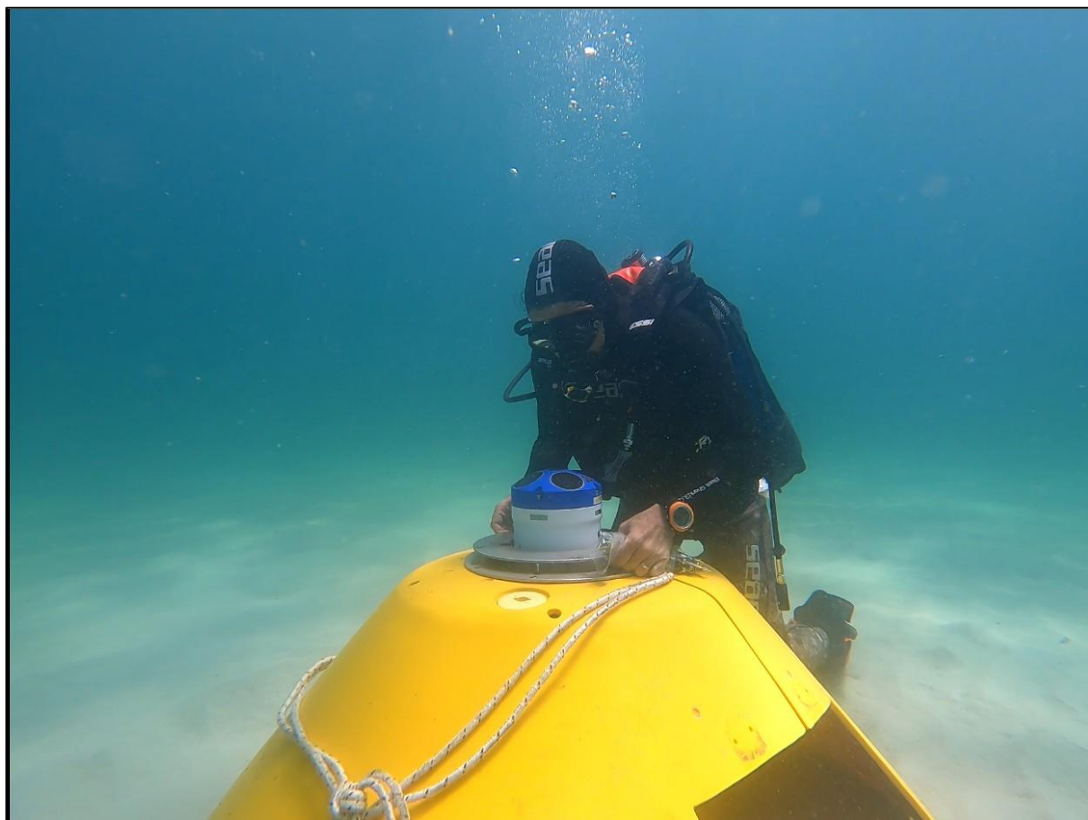
Figura 19 – Fase di installazione dell'ADCP
