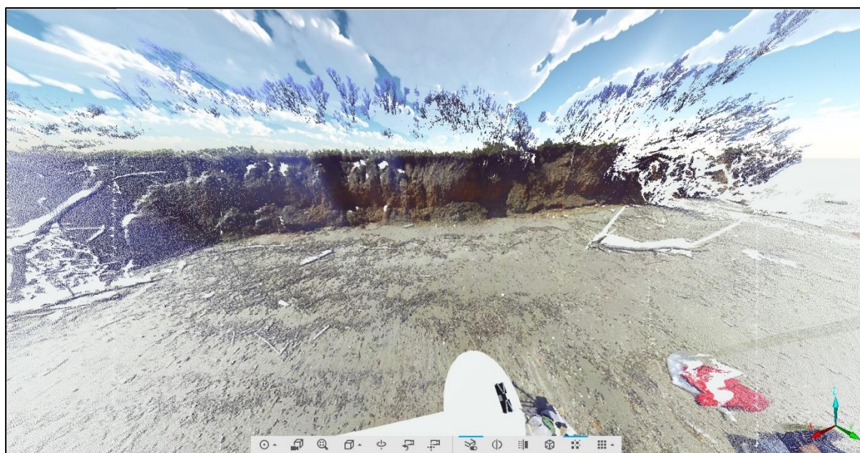
Figura 52 – Software Faro Scene – Nuvola di punti 3D
