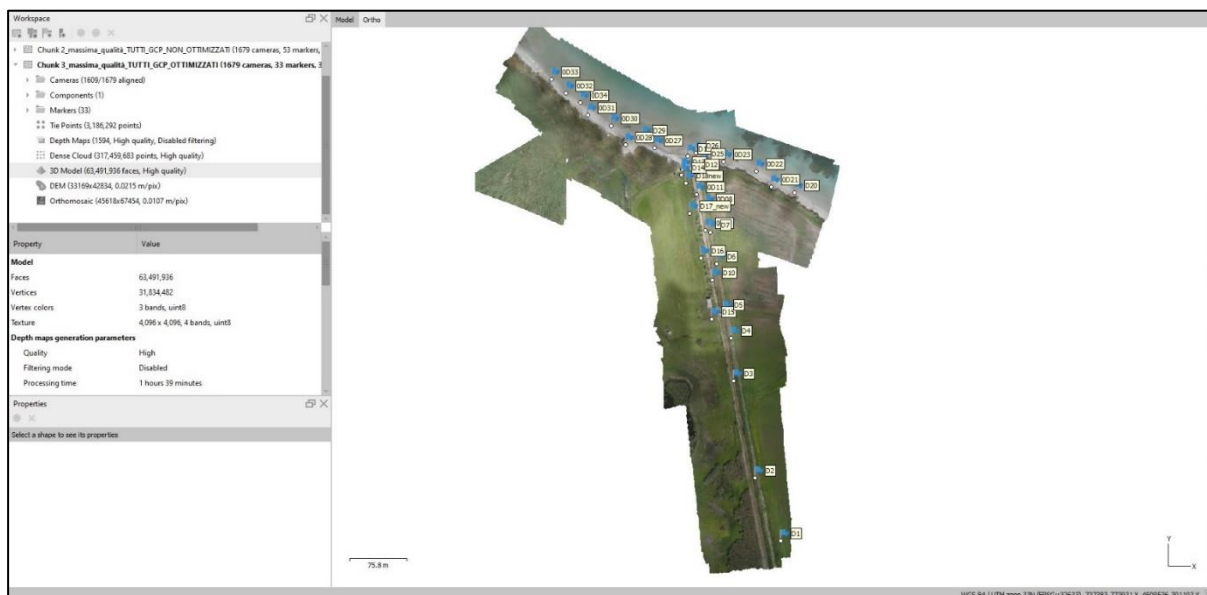
Figura 43 – Generazione dell'ortomosaico con i GCP
