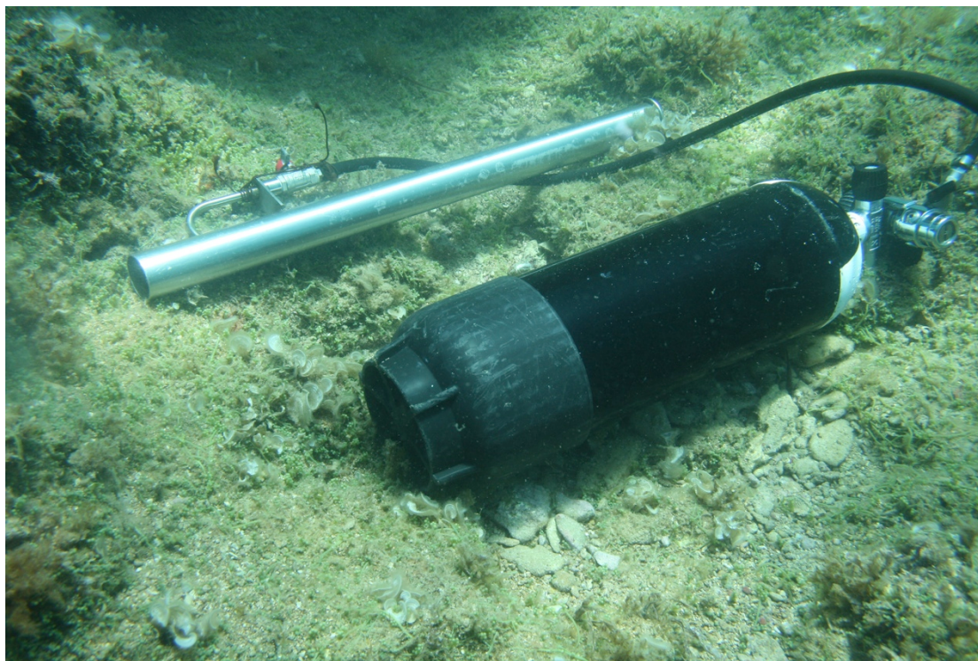
Fig. 2.2.I. Sorbona per il campionamento della macrofauna dei sedimenti associati alla matte di P. oceanica .
